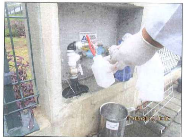
Figura 20: Coleta de amostra de água tratada Rua Manoel Roque – Fórum.
