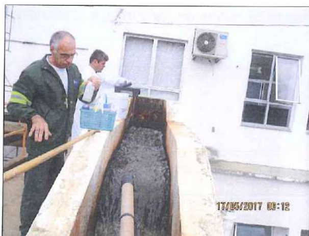
Figura 1: Captação de amostra da água bruta do Rio do Peixe na ETA de Videira.
